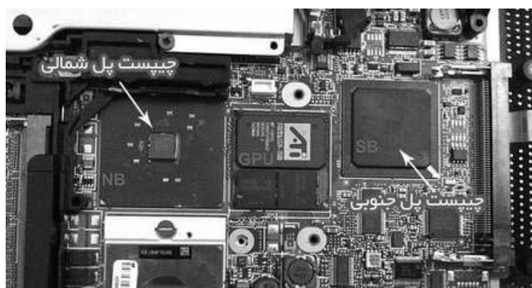
شکل (۲-۵) Chipset پل شمالی و جنوبی را روی مادربرد لپ تاپ نشان می‌دهد.
