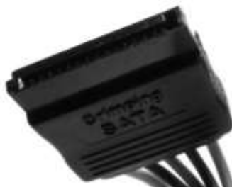
شکل (۲۱-۶) یک کانکتور برق برای اتصال به هارد یا سایر ابزارهای SATA را نشان می‌دهد.
