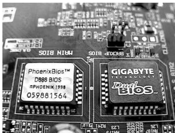
شکل (۱۲-۵) محل BIOS سیستم را روی برد اصلی نشان می‌دهد.
