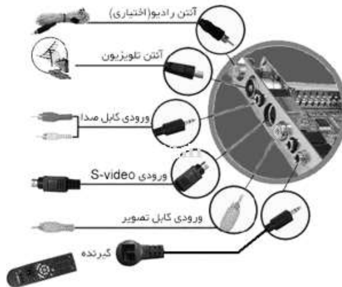
شکل (۶-۳۸) بخش‌های ورودی و خروجی یک کارت TV را نشان می‌دهد.
