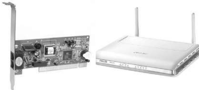
شکل (۴۰-۶) دو نوع Modem از نوع Internal و External را نشان می‌دهد.
