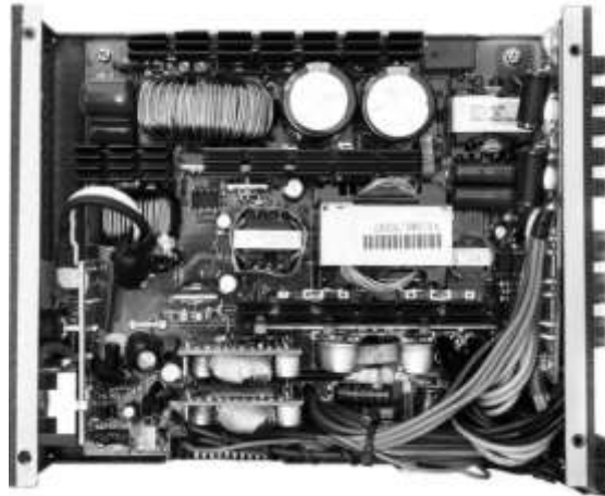
شکل (۱۶-۶) ساختار داخلی یک پاور را نشان می‌دهد.
