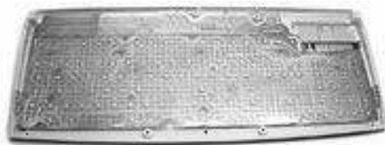
شکل (۷-۳) مدار ماتریسی کلیدها را نشان می‌دهد
