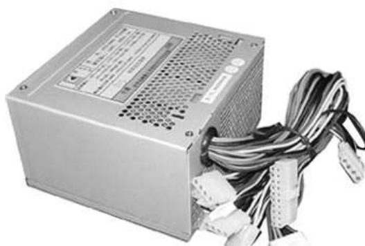
شکل (۶-۲۲) کانکتور ها و اتصالات مختلف یک منبع تغذیه را نشان می دهد.
