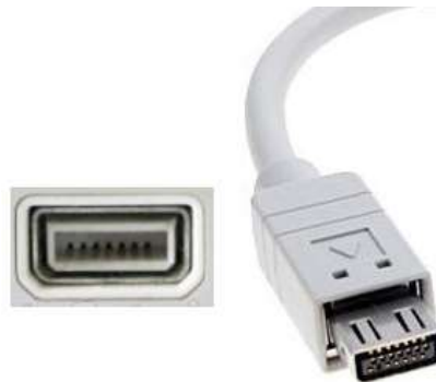
شکل (۶-۳۰) یک درگاه Mini VGA نشان می‌دهد.
