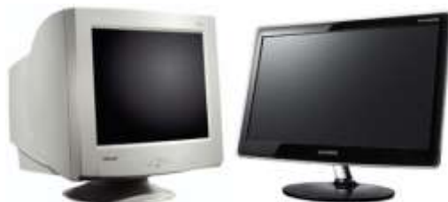
شکل (۷-۷) دو مانیتور LCD و CRT را نشان می‌دهد.
